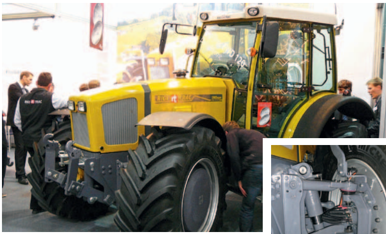
Leider nur als Prototyp wurde der RigiTrac mit vier Radnarbenmotoren vorgestellt.
