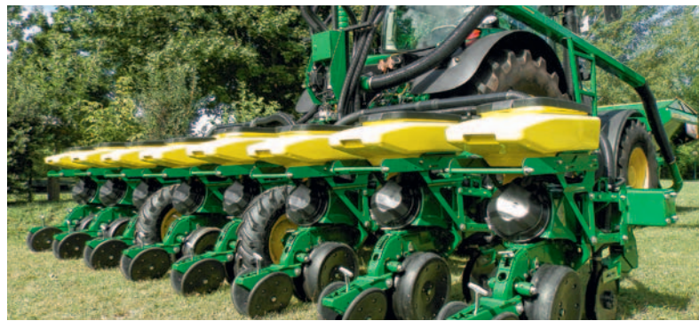
Präziser dosieren ist mit Elektromotoren an der Säeinheit möglich wie bei der John Deere Einzelkornsämaschine ExaktMerge.
