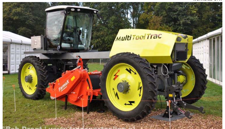
Beim Multi Tool Trac können alle üblichen Anbaugeräte an Heck, Front und zwischen den Achsen (langer Rahmen) angebaut werden.
