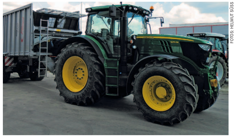
Bessere Antriebs-effizienz: Der Fliegl-Abschiebewagen mit elektrischer Triebachse, gespeist vom teilelektrifizierten John Deere RE.
