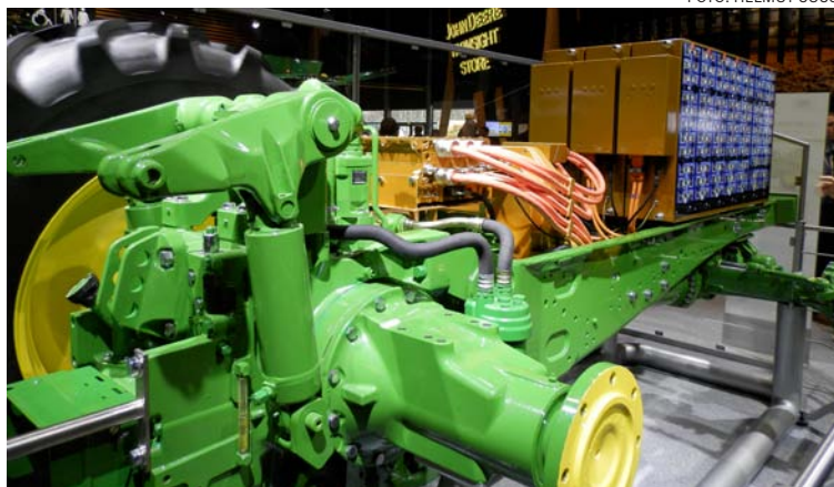
Beim SESAM-Traktor treiben zwei wartungsfreie Elektromotoren bzw. Lithium-Akkus das serienmäßige DirectDrive-Getriebe an.
