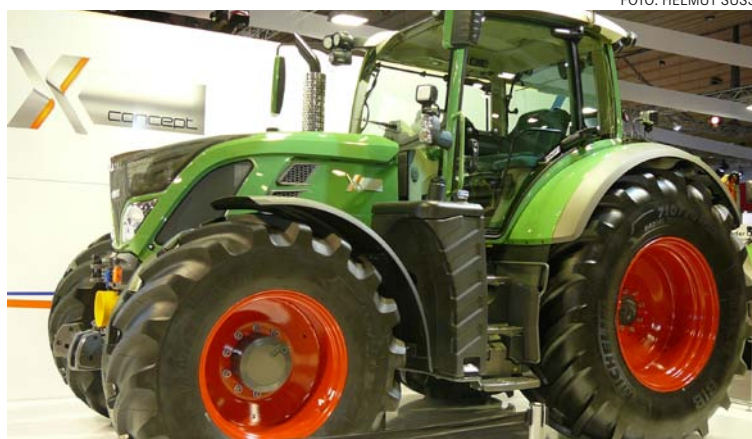
Beim X-Concept wird die elektrische Leistung mit 700 V Gleichspannung über den Powerbus an die Geräte übertragen.
